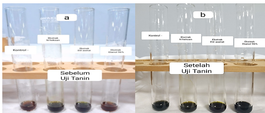
Gambar 5. Hasil uji tanin ekstrak daun kersen segar (a) sebelum dilakukan uji senyawa tanin (b) setelah dilakukan uji senyawa tanin
