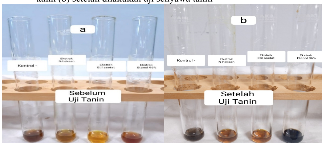
Gambar 6. Hasil uji tanin ekstrak daun kersen kering (a) sebelum dilakukan uji senyawa tanin (b) setelah dilakukan uji senyawa tanin
