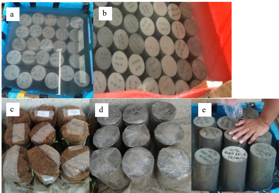
Gambar 2. Metode perawatan: a. direndam air biasa (P-RAB), b. direndam air laut (P-RAL), c. dibungkus karung goni (P-BG), d. dibungkus plastik (P-BP), e. disiram-siram (P-SS)
