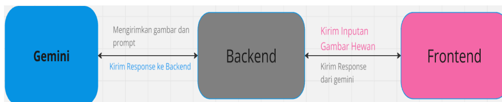
Gambar 3 Blok Diagram Aplikasi Pendeteksian Ras PetGuardian
