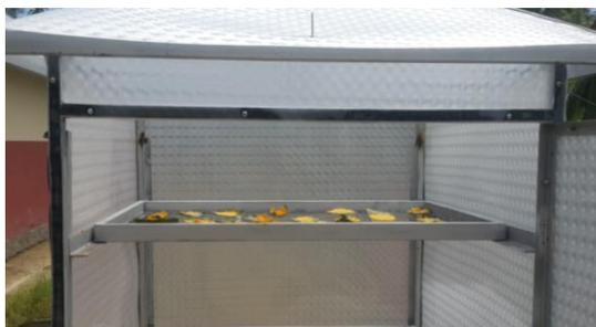
Gambar 7. a. Mengatur emping pada rak, b. Alat pengering radiasi surya.
