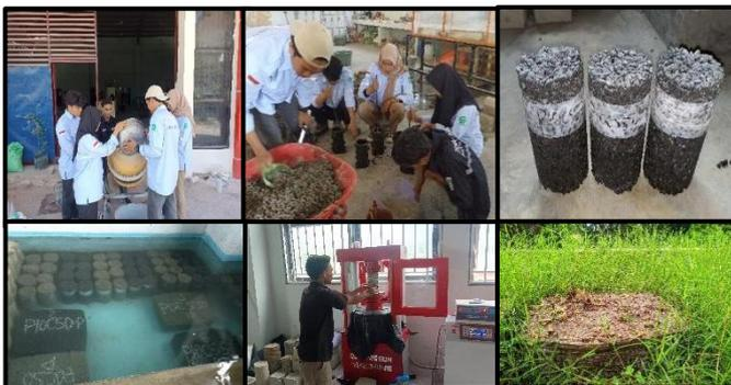
Gambar 2. Proses pembuatan, pencetakan, dan perawatan benda uji dengan air tawar.
