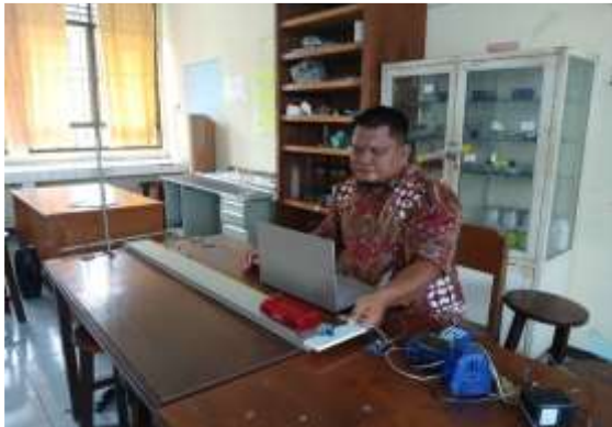
Gambar 6. Setup eksperimen hukum Newton menggunakan HC-SR04
