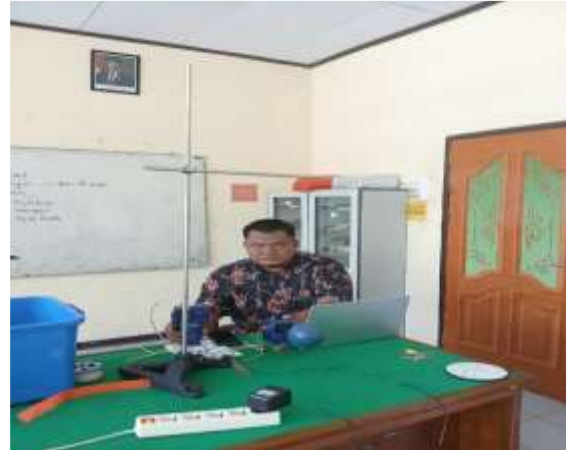
Gambar 4. Setup eksperimen bandul menggunakan sensor PASCO
