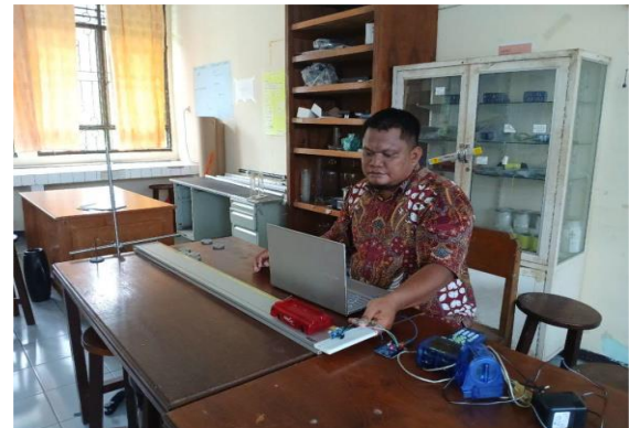
Gambar 6. Setup eksperimen hukum Newton menggunakan HC-SR04
