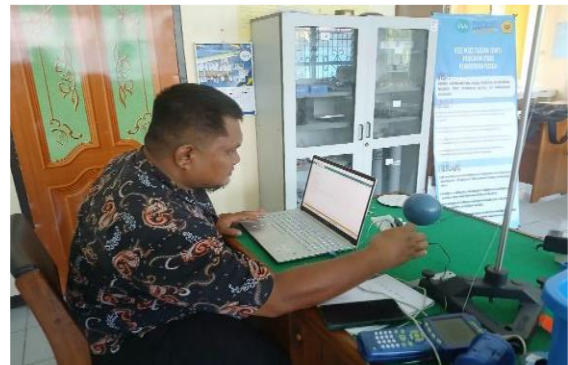
Gambar 2. Setup eksperimen bandul sederhana menggunakan sensor HC-SR04
