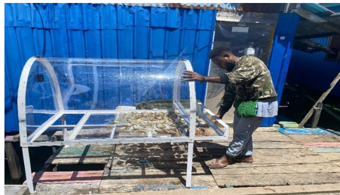
Gambar 3. Alat Pengering ikan berbasis rumah kaca
