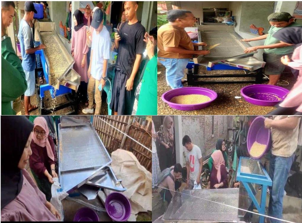
**Gambar 7.** Demonstrasi Mesin Sortasi Biji Kedelai
