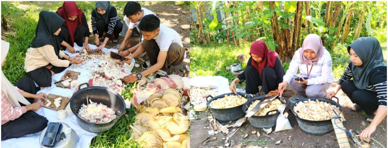
Gambar 4. Pencacahan pelepah pisang dan pembuatan larutan rendaman alkali
